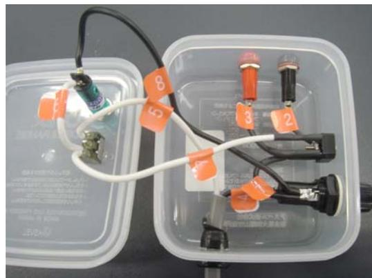
図5 ケース内の配線。ネオンブラケットとスイッチの取り付け位置に、他のパーツがこないように固定するのがコツです。また、配線は長過ぎず、短過ぎずを心掛けます。写真にある番号順に結線すると、ハンダ付けが比較的容易になります。
