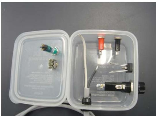
図3 ケースにパーツを取り付けます。ダイオードブリッジは2.5mmのネジで固定します。またパーツにはあらかじめハンダを流します。
