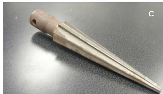
図2 (a) ケースに穴をあける。ボール盤が使える環境であれば申し分ないのですが、ハンドドリルでも十分代用可能です。それも無ければ、コンパスの針を熱してプスッとやればそれでも可能です。(b)(c)小さな下穴があれば、それをコジッて必要な大きさに広げます。リーマーがあれば理想的ですが、カッターでも十分可能です。
