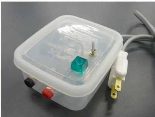
図1 簡易的な電気泳動用電源装置
