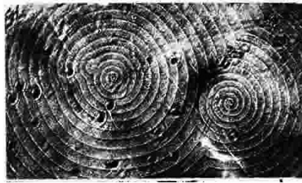
図3 S. Amelinckx がカーボランダム結晶 (0001) 表面上で、単位格子高さ (1.51 nm) のらせん成長ステップを観察し、Frank 機構が正しいことを証明した。S. Amelinckx, Nature , 167 (1951) 939.
